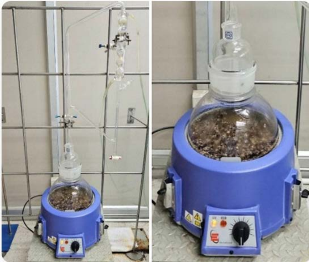
ภาพที่ 2 การกลั่นน้ำมันหอมระเหยเมล็ดกระวานโดยวิธี Water distillation
